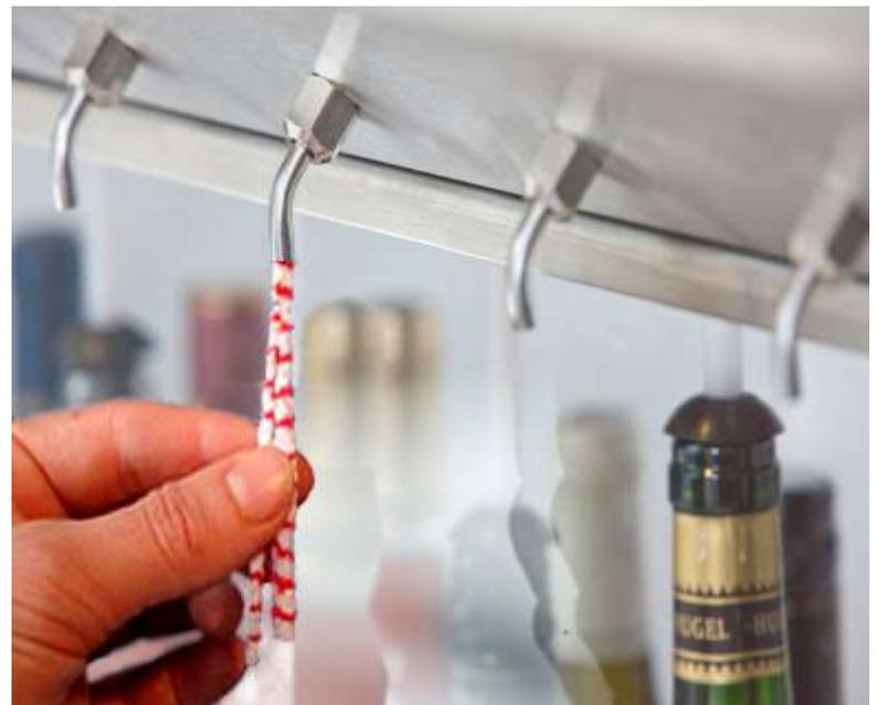
**Wischen Sie die Hähne deshalb regelmäßig ab, und reinigen Sie sie mit einem befeuchteten Pfeifenreiniger.**
